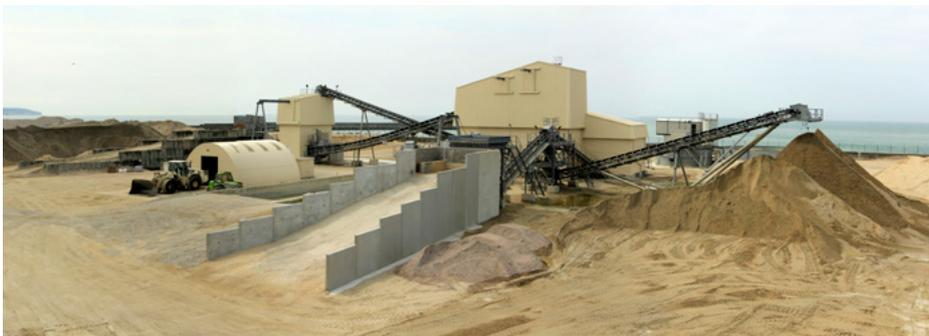
Traitement : criblage, concassage et séparation du sable fin
