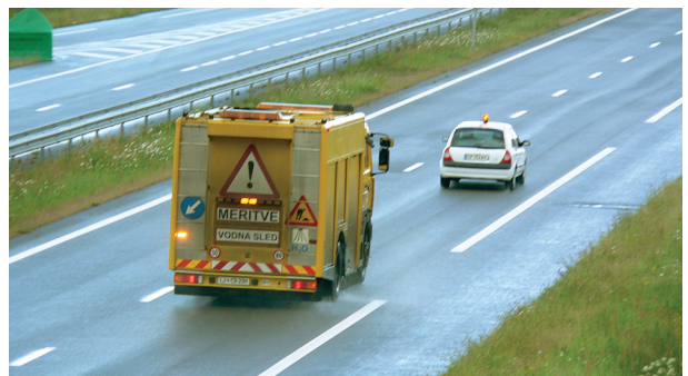
Mesure d'adhérence sur route ouverte au trafic
