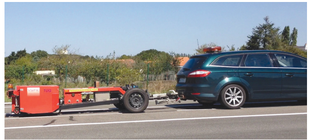
Remorque de mesure de la résistance au roulement de l'Université de Gdansk (TUG)
