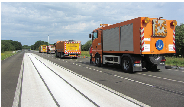
Mesures comparatives d'adhérence sur la piste de l'Ifsttar
