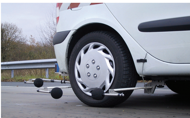
Mesure en continu du bruit pneu-chaussée
